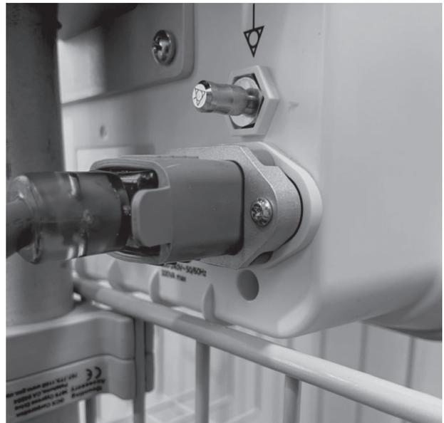
図4 ポンプユニット電源コード入力カバー
